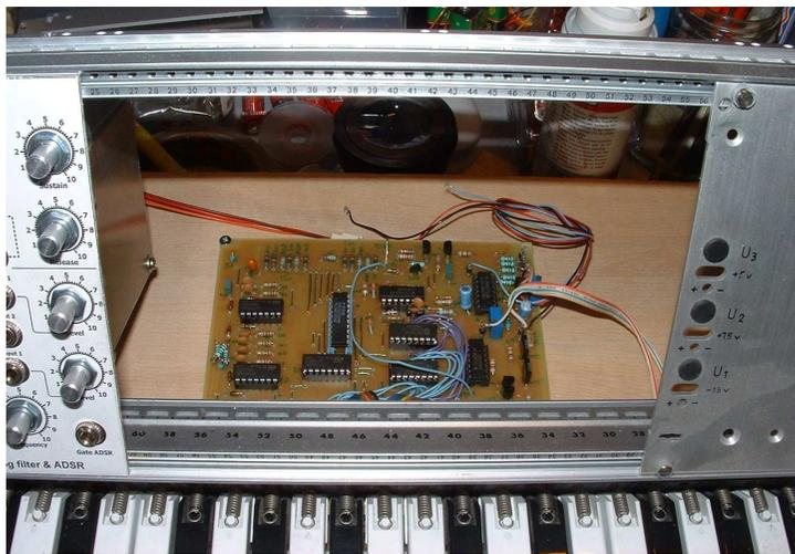
Aperçu de l'encodeur MFOS à circuits CMOS.....
