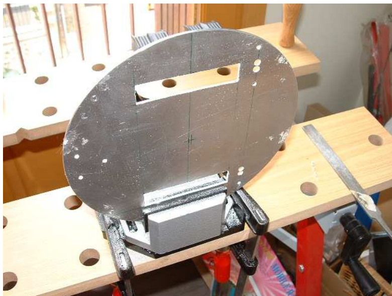
Usinage « maison » du plateau de base
