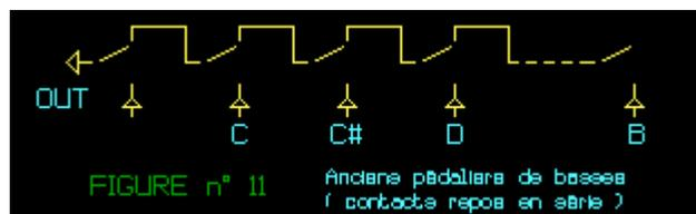
Ce sont des contacts en série, et seul le repos de l'un permettra l'action d'un autre, plus loin dans la chaîne. Le réglage d'un tel contact consiste donc à ce que les positions travail et repos soient respectées (**figure n°12**).
